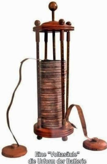
Eine "Volta'sche Säule" die Urform der Batterie
